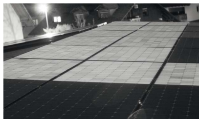
Elektrolumineszenzaufnahme zum Aufspüren eines Modulstranges
